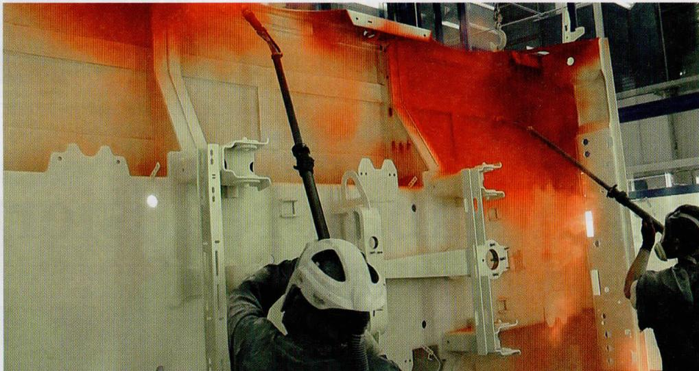
Positiv auf die Entwicklung des Pulver-in-Pulver-Verfahrens wirkte sich der Einsatz der Tribo-Masterlanze aus. Bei dem Gerät handelt es sich um ein Applikationssystem, das über eine teleskopierbare Lanze mit einem sehr kurzen und beweglichen Tribo-Sprühkopf verfügt.
