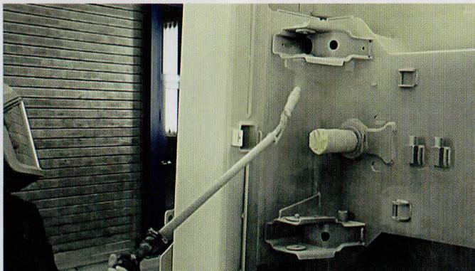
den wie Wirtgen – weiterentwickelt und kann jetzt, wie bei der DLA erwiesen, nahezu zwei Corona-Pistolen ersetzen. „Durch die Applikationstechnik ist der reine Beschichtungsprozess zweimal schneller als mit Corona und viermal schneller als bei Flüssiglack. Jährlich erreichen wir dadurch 20% mehr Output bei gleichem Zeitbudget“, fasst der Leiter der Oberflächentechnik
